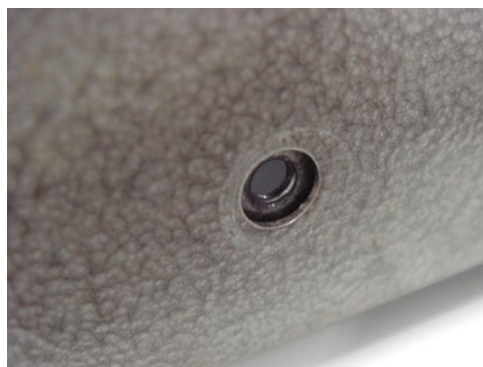
ビスやナットが接触する部分は塗装を剥がす
