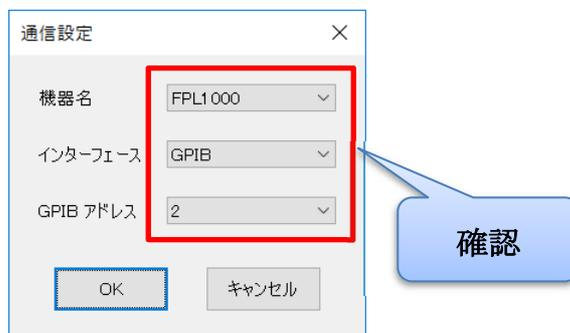
スペクトラムアナライザ本体の GPIB アドレス「2」と EPS-02Ev3 の通信設定の GPIB アドレス「2」が同じであることをご確認ください。なお、GPIB アドレス「0」は、GPIB コントローラ用に予約されているため使用できません。
