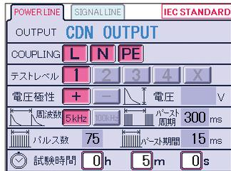
IEC 61000-4-4で定められた試験条件がプリセットされています。電源電圧への重畳では0.5kV、1.0kV、2.0kV、4.0kVとパルス周波数(5kHz/100kHz)となります。
