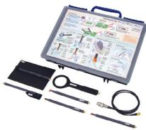
プリント基板のパターンやフラットケーブル等にノイズを印加できます。プローブの使い分けにより電界/磁界を近傍より照射する事が可能です。
