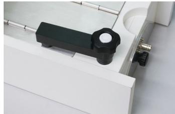
IEC 61000-4-4 Ed.3 規格の要求に基づく、信号線への容量性結合試験を行うためのカップリングクランプです。
