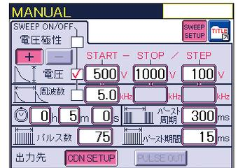
出力電圧やパルス周波数の変化条件を予め設定し、自動的に実行する試験モードです。設定画面例では500Vから1000Vまで250Vステップでバースト電圧を変化させる設定です。ELUTの誤動作点を判定するのに便利な機能で、出力電圧、パルス周波数、極性、電源印加相、印加位相の条件変化を設定できます。
