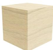
床置き機器などに対する静電気試験を行なう際に、機器をグラウンドプレーンより 10cm 浮かすために使用します。
