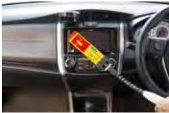
広帯域スリープアンテナを使用した車内での試験イメージ
